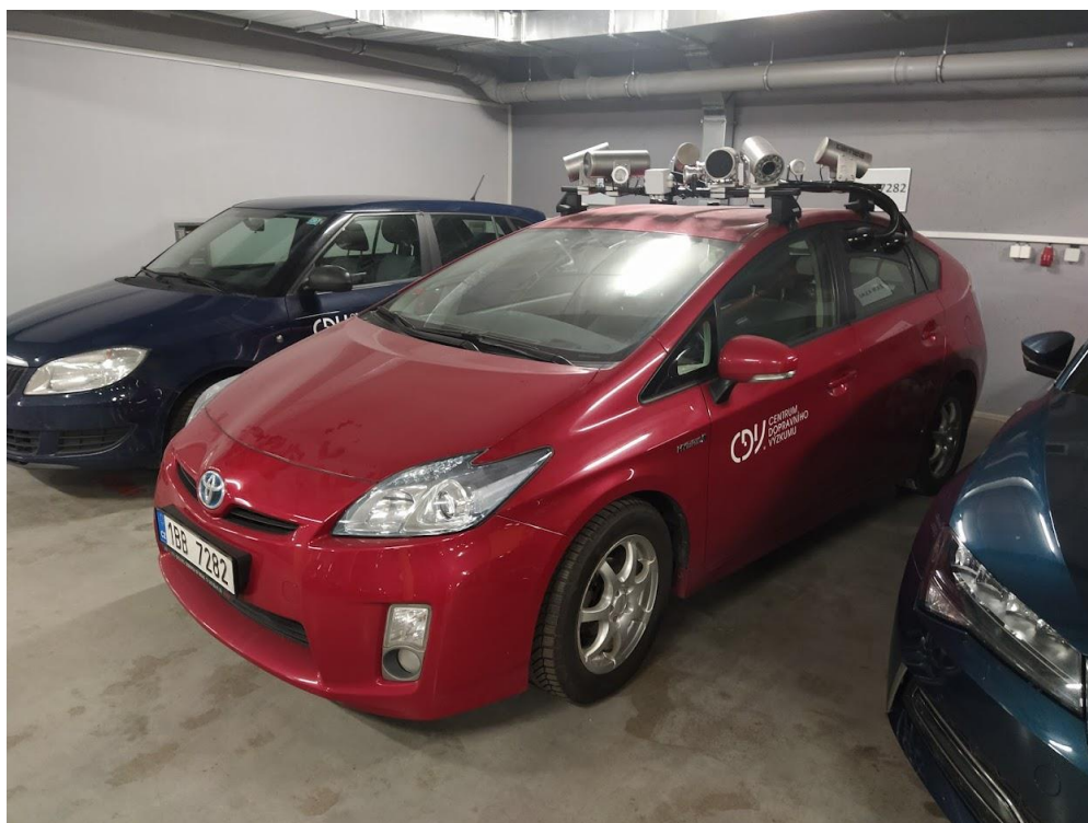
Obrázek 3: Vozidlo pro monitorování statické dopravy
