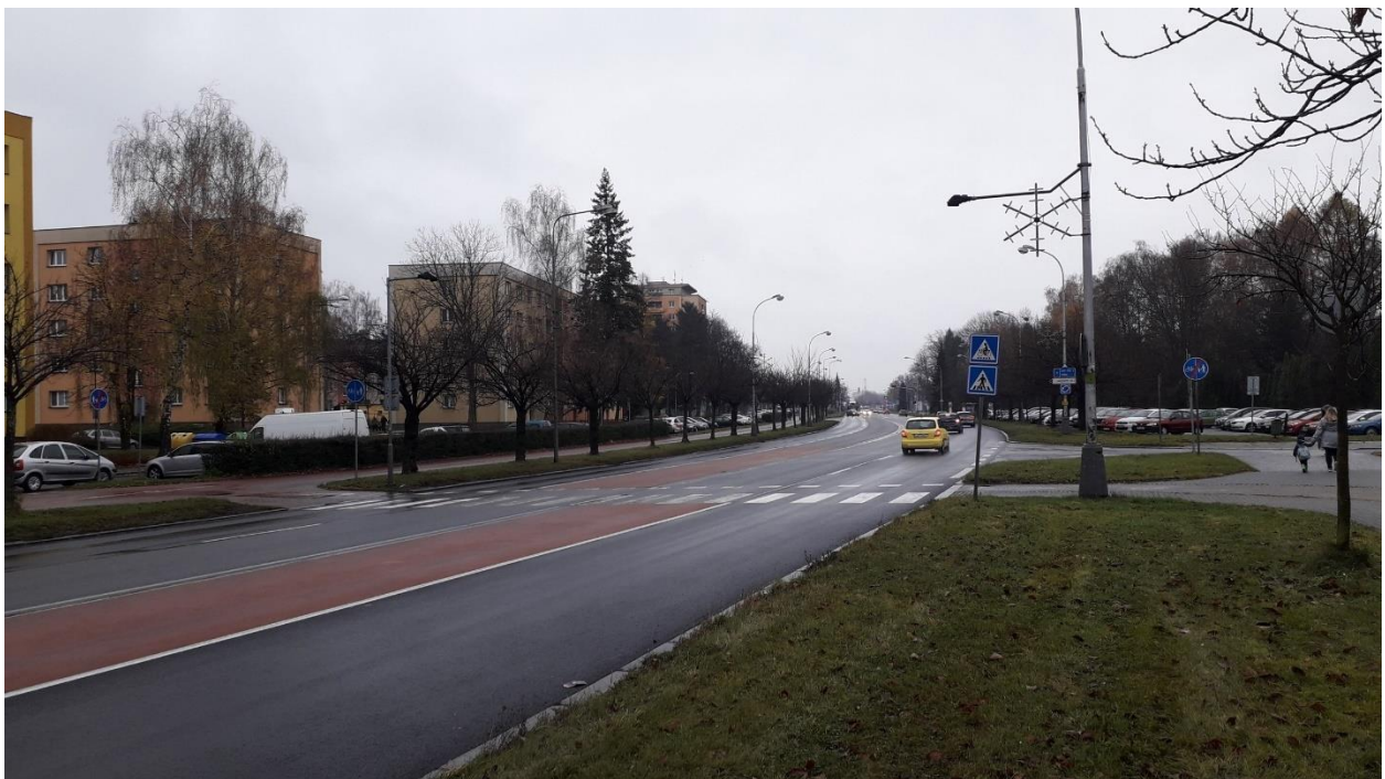
Obrázek 47 Přímknutý přejezd pro cyklisty, umožňující přejezd mimo křižovatky
